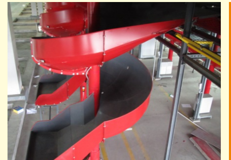
螺旋滑轨/滑槽 适用领域：小型周转箱输送 性能特点：占地少，无功耗
