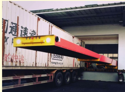
伸缩皮带输送机 输送速度：0.75米/秒 输送机节数：2、3、4节
