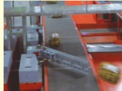
挡臂分路器 输送效率：1800件/时 最大分拣重量：100公斤 性能特点：结构简单，一进两出
